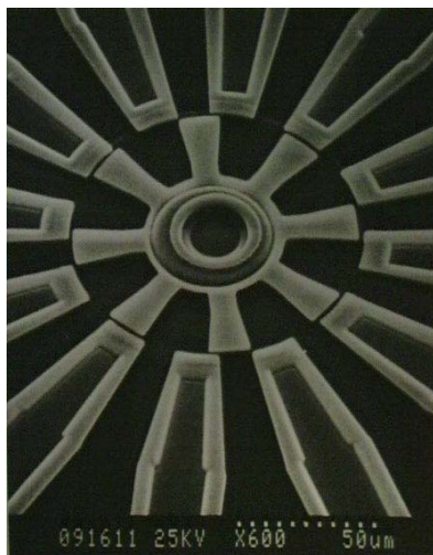
静電マイクロモータ (MIT 米)
