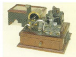
サイフォンレコーダ 右側のインクつばから左側に延びているガラス管式のペン先を、受信信号で動かし、紙テープ上に受信波形状を記録する。
