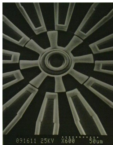
静電マイクロモータ (MIT 米)
