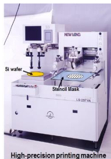
Au 粒子ペーストパターンのステンシル印刷 (AuRoFUSE™)
