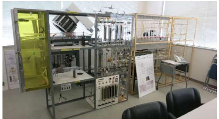
自作装置(Si 成長装置用ガラス配管(右)、大気圧 CVD 装置(左))
