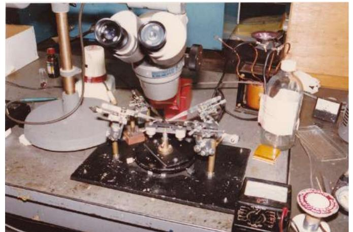
微小はんだ付け(導電性接着)装置
