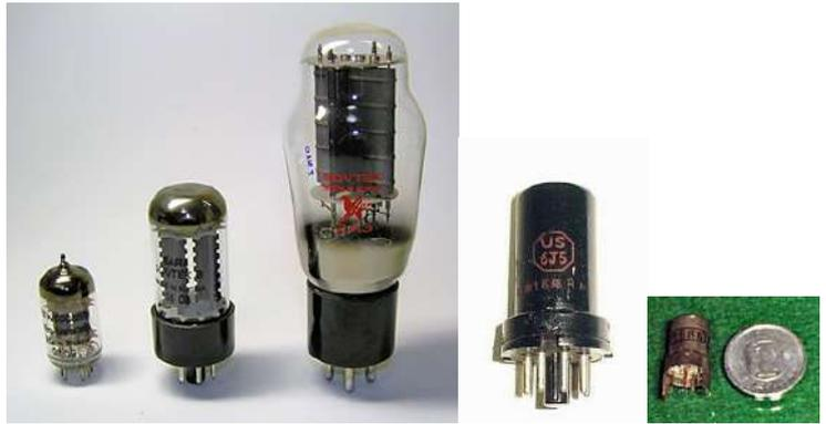
二極真空管 三極真空管 三極真空管 MT 管 GT 管 ST 管 メタル管 ニュービスタ
