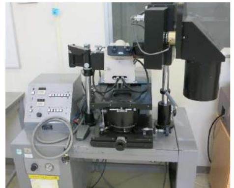
片面密着露光装置とそれを改造した両面密着露光装置
