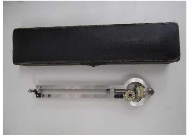
比例コンパス（長さ、面積、体積、円などの拡大や縮小）[1] グラニメータ（地図など平面上の図形の輪郭をなぞることにより、その面積を計測する装置）
