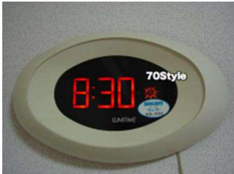
交流モータ駆動 機械式ネオン管表示時計 (1970年代 田村電機製)
