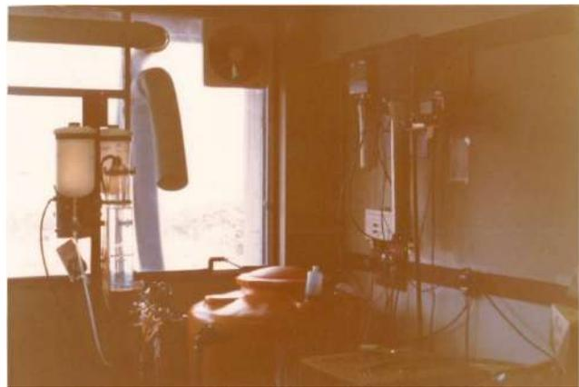
EPW による Si エッチャ、熱リン酸による Si<sub>3</sub>N<sub>4</sub> エッチャ、Si 電解エッチング装置
