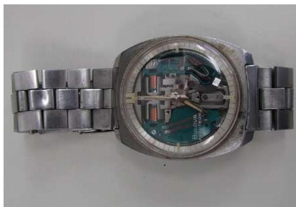
音叉腕時計 (1960年 スイス Bulova Accutron 製) [2]
