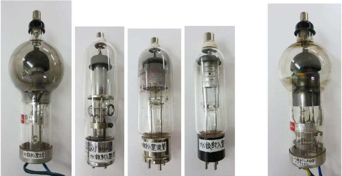
水銀整流管 5H69                      872A                      4H72                      2H66                      サイラトロン(電力制御用) (5G69)
