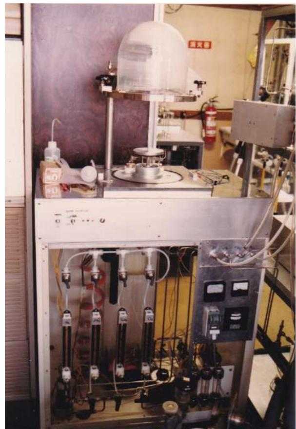
$\text{SiO}_2$ 用 低温CVD炉
