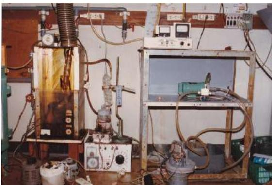
ウェットエッチング( $\text{Si}_3\text{N}_4$  他)
