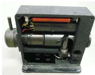
ゴーレーセル (気体の熱膨張による赤外光の検出)
