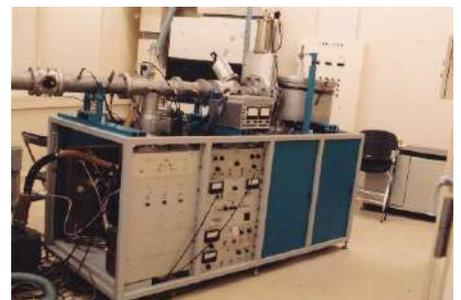
イオン注入装置（アクセルレータ社 200kV 前段加速型）
