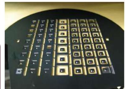
受講生が3ヶ月で試作した容量型3軸加速度センサ
