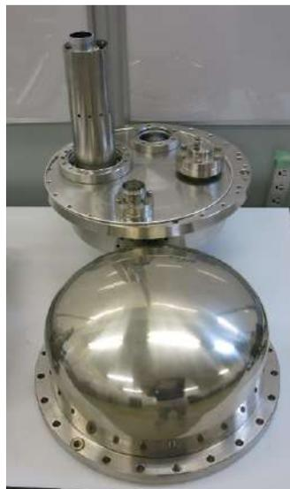
半球型電子エネルギーアナライザ(展示)を用いた X線光電子分光装置
