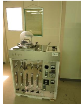
D. Low temp CVD(SiO 2 , PSG)
