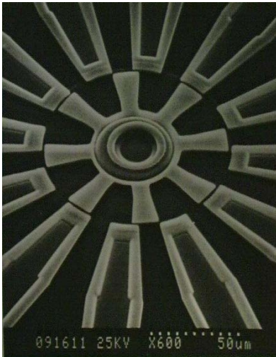
Electrostatic micro motor (MIT USA)
