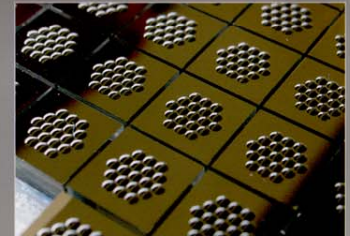
ガラス上のポリマー、レンズ・アレイ、開口構造、および裏側に金属ピンホールが付いたウエハー・カット後のマイクロ光学チップ
