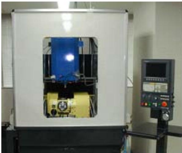
タービンの製作に用いた 5 軸ステージ高速スピンドル加工機 (東芝機械 F-MACH)
