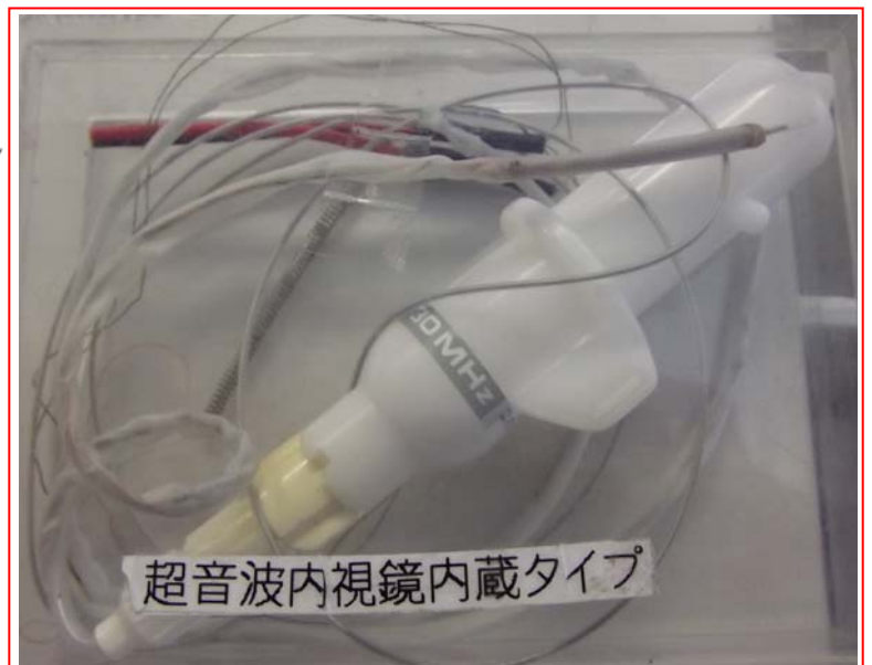
SMA 能動屈曲機構を備えた細径超音波内視鏡
