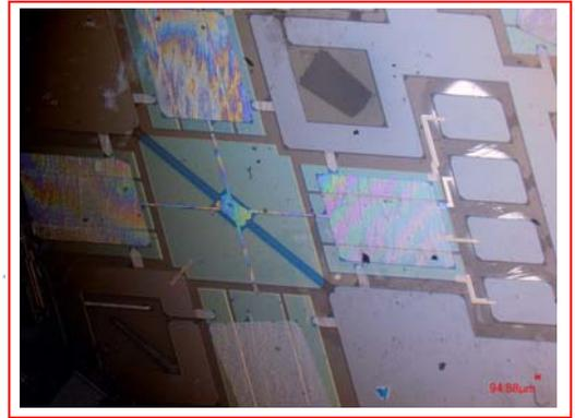
静電力の共振周波数調整機構を持つ静電駆動容量検出ジャイロ (東北大学 - 松下電器)
