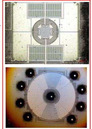
回転振動型静電駆動容量検出ジャイロ(東北大学 - フォード自動車)(東北大学 - トヨタ自動車)
