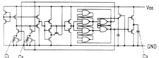
差動容量型 2 線式 加速度・温度センサ
