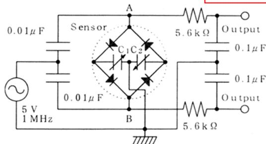
ダイオードブリッジ集積化容量型加速度センサ
