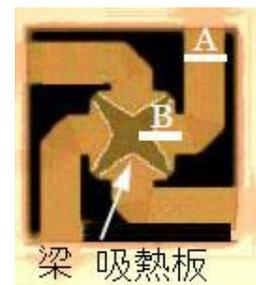
レンズ一体型超小型非接触温度センサ(集積化サーモパイル赤外線センサ) (リコー)
