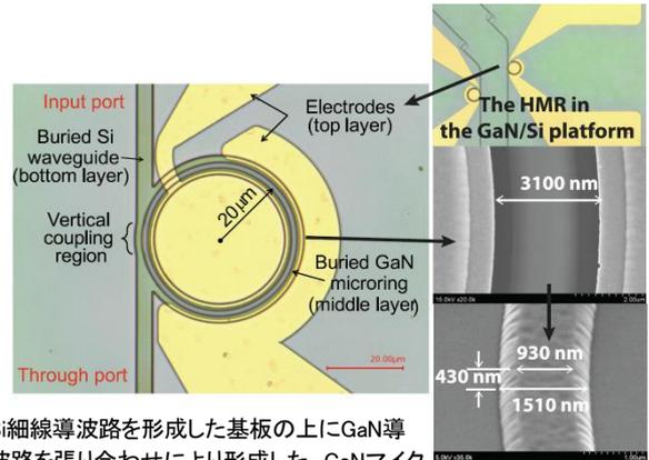
Si細線導波路を形成した基板の上にGaN導波路を張り合わせにより形成した。GaNマイクロリング導波路は電気光学効果により屈折率が変わられるので、高速変調器として動作できる。B. Thubthimthong, Appl. Phys. Lett. 122 (2018) 071102
