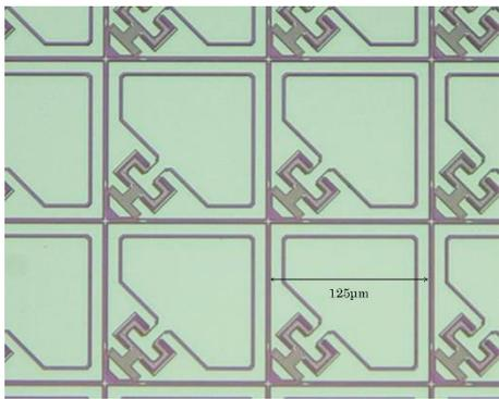
Si細線導波路を用い、静電くしアクチュエータにより導波路カプラーの間隙を変えて、光路を変える。マトリクス状の導波路の交点部分に2つの可動カプラーがあり、駆動される。データセンター用のクロスコネクタとして開発した。関連文献: S.Abe, Photon.Technol. Lett. 26 (2014) 1553
