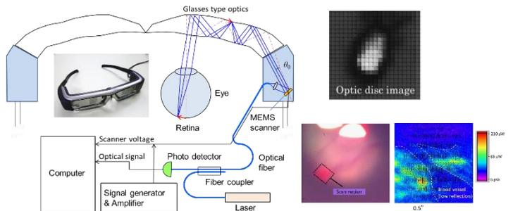
スマートグラスを用いた眼底検査装置, 豚の眼を用いた網膜の測定像 N.Kaushik, International Display workshops, Dec. 6-8, 2017, Sendai
