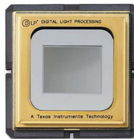
ビデオプロジェクタ用ミラーアレイ DMD (Digital Micro mirror Device) (米 テキサスインスツルメンツ(TI)社)
