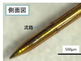
φ200 μm 鍼灸針に作製された流路
