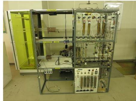
F. 大気圧 CVD 装置(poly Si,  $\text{Si}_3\text{N}_4$ ,  $\text{SiO}_2$ )と加熱用 RF 電源(裏側)
