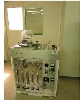
D. 低温 CVD 装置( $\text{SiO}_2$ , PSG)
