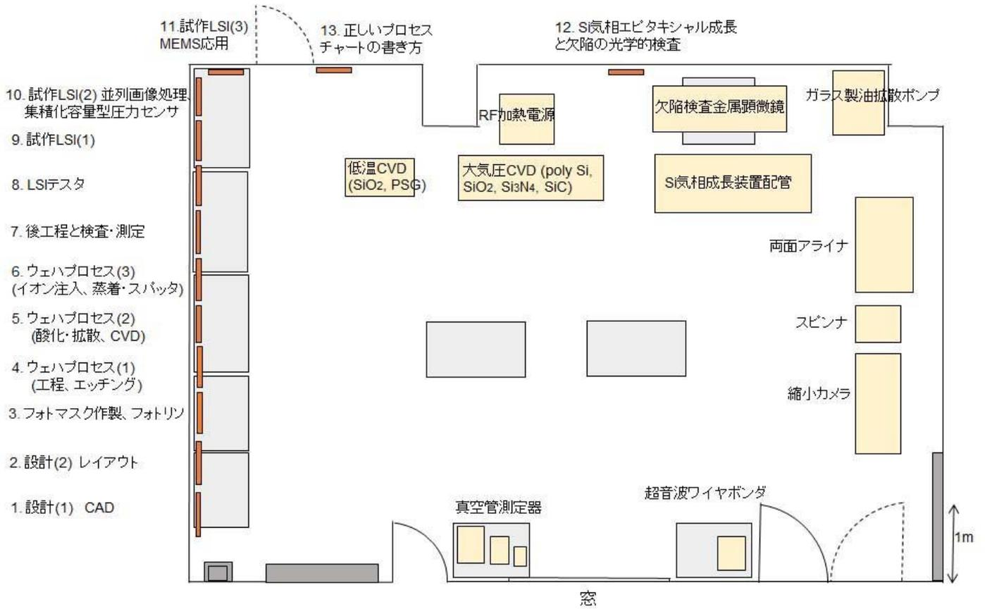
試作装置見学室 (自作装置によるCMOSLSIの設計試作)
