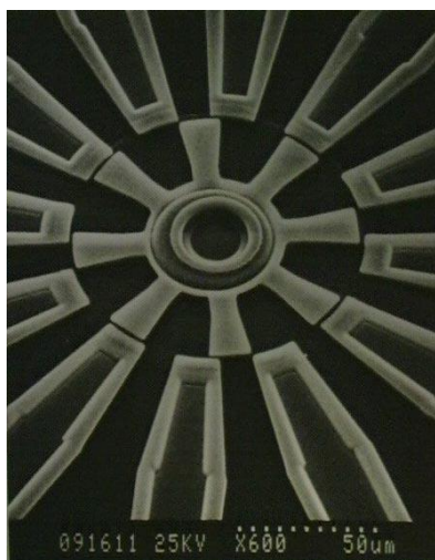
Electrostatic micro motor (MIT USA)
