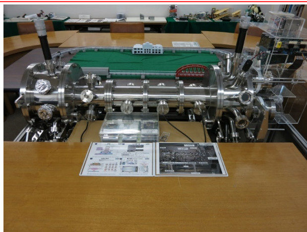
100 × 100 アクティブマトリックス電子源(右)による超並列電子ビーム描画装置
