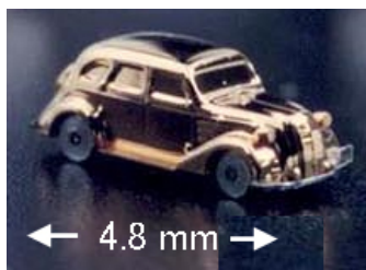
自動車トヨタ AA (1936 年)とその 1/1000 モデル (62mg、24 部品)
