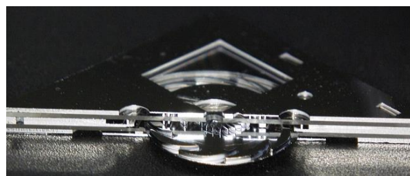
内向流ラジアル軸受けを用いた Si エアタービン
