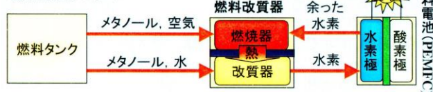
燃料電池システム
