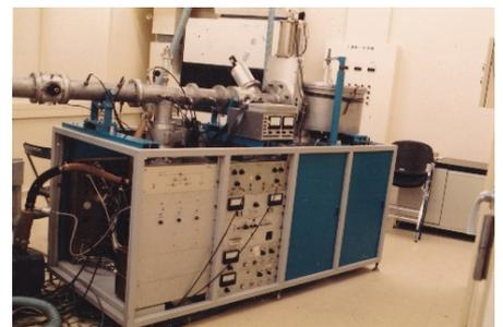
イオン注入装置（アクセレータ社 200kV 前段加速型）
