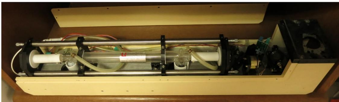
気体レーザー（展示）（下は炭酸ガスレーザー）
