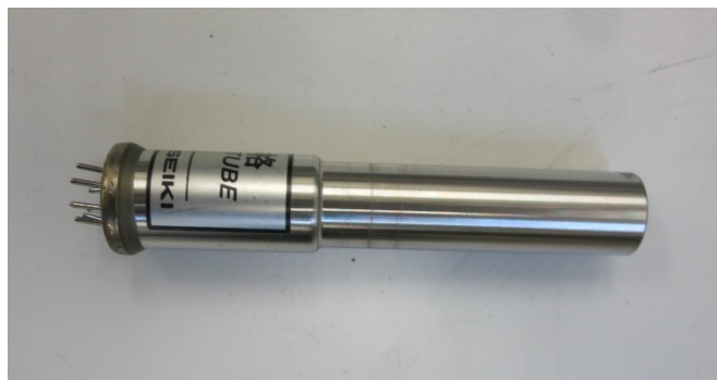
真空度により抵抗が変化するピラニゲージ (展示)
