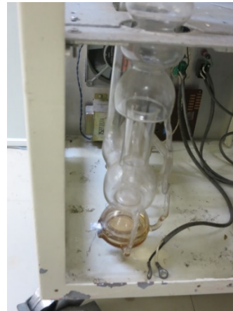
(油)拡散ポンプの原理・構造・写真（展示(ガラス製 熊野勝文氏製作)）
