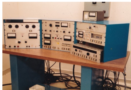
イオン注入装置（アクセレータ社 200kV 前段加速型）
