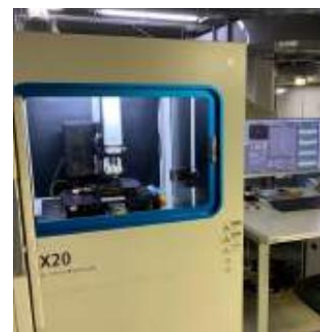
原子間力顕微鏡(AFM) (Park Systems NX-20)
