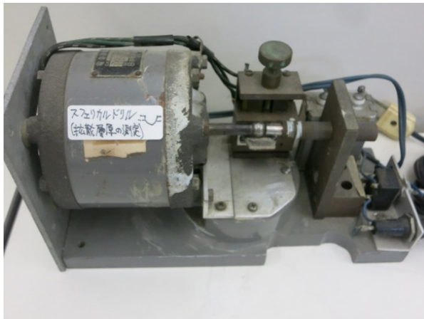
スフェリカルドリルで球面状に研磨後、p Si に着色し顕微鏡で拡散深さを測定
