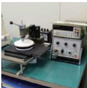
四探針法によるシート抵抗測定
