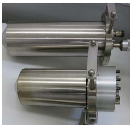
同軸電子エネルギーアナライザ(CMA)(展示)を用いたオージェ電子分光装置
