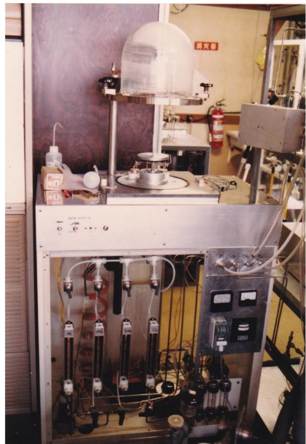
$\text{SiO}_2$ 用 低温CVD炉
