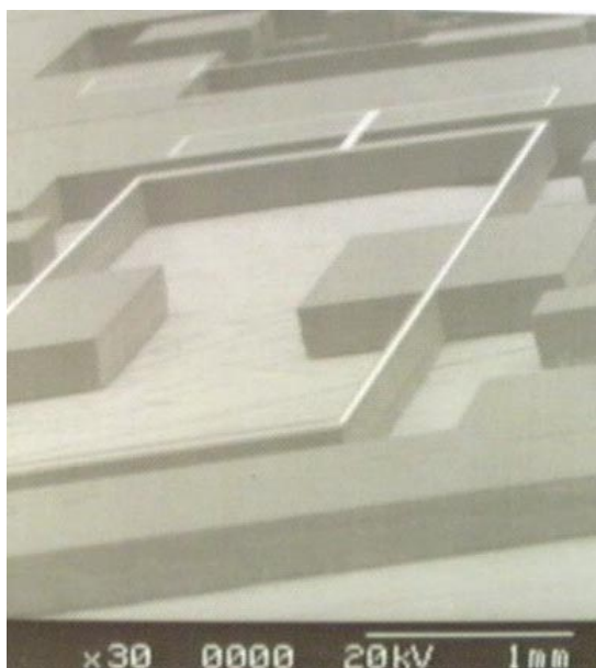
Si Deep RIE のウェハ貫通エッチングによる振動ジャイロ
