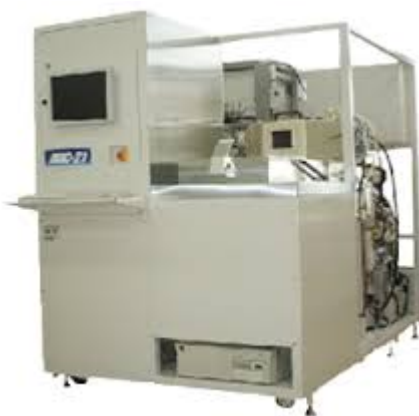
アルカテル社の Deep RIE 装置 (展示) SPP Technologies (住友精密工業)社の装置
