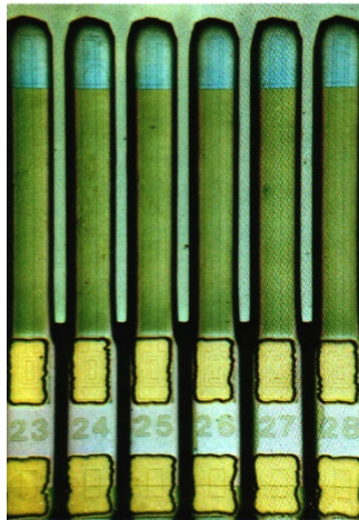
ISFET (Ion Sensitive Field Effect Transistor) と マイクロ ISFET (右)
