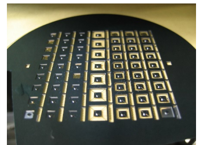
受講生が3ヶ月で試作した 容量型3軸加速度センサ
