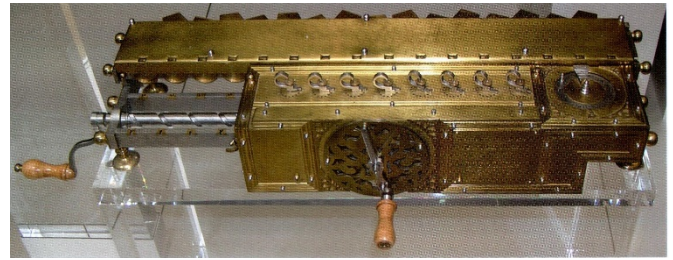
ライプニッツの段付歯車を用いた計算機 (1700 年頃) (非展示) (コンピュータ開発史 大駒誠一 共立出版 (2005))
