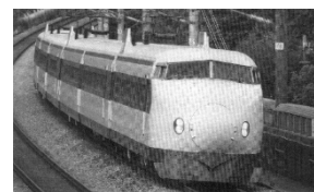
0 系 (1964 年~) ダイオード + 変圧器 端子切り替え
