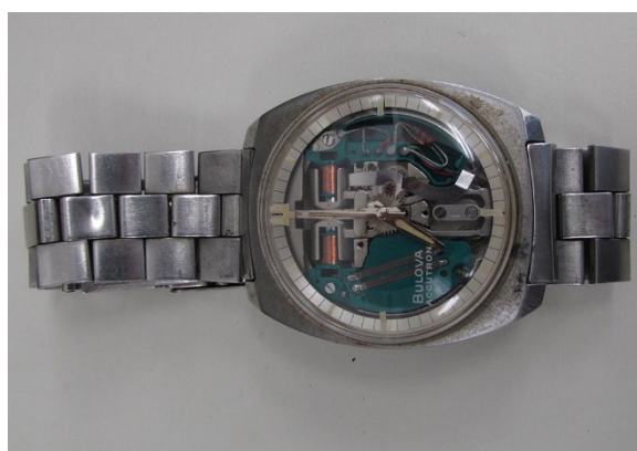
音叉腕時計 (1960 年 スイス Bulova Accutron 製) [2]
