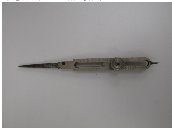
比例コンパス（長さ、面積、体積、円などの拡大や縮小）[1] グラニメータ（地図など平面上の図形の輪郭をなぞることにより、その面積を計測する装置）
