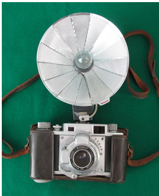
リコー35 カメラ (1950 年代) 初期の理研光学のレンズシャッター35mm フィルム用カメラ[1]
