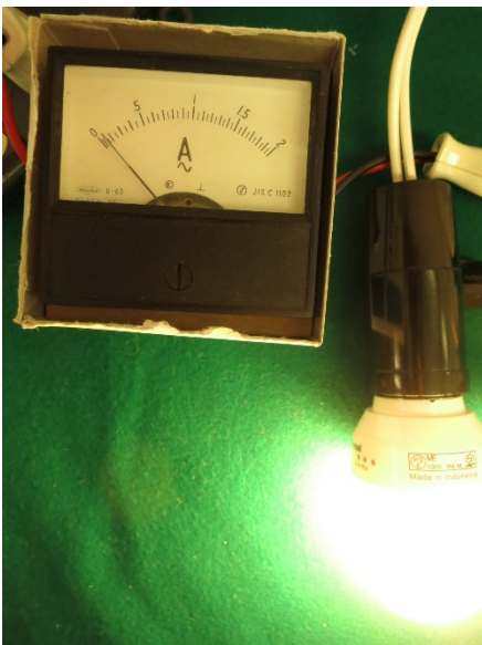
40W 相当蛍光灯(8W 消費) 電流測定比較実験
