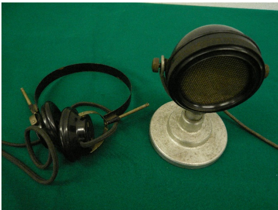
電磁式ヘッドホンと炭素粒マイクロホン[1] エジソン(1877)
