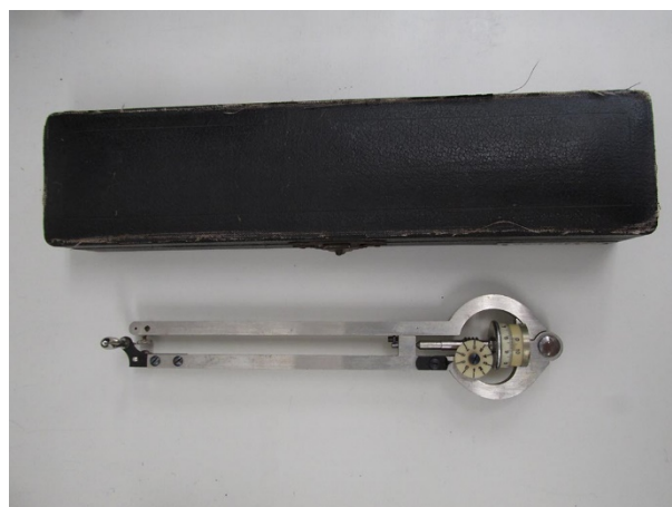
プランメータ（地図など平面上の図形の輪郭をなぞることにより、その面積を計測する装置）
