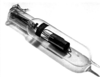
岡部が発明した分割陽極型マグネトロンの試作品
