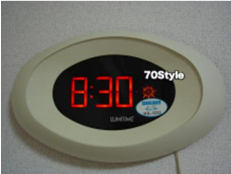
交流モータ駆動 機械式ネオン管表示時計 (1970年代 田村電機製) (1970年代 田村電機製) [1]
