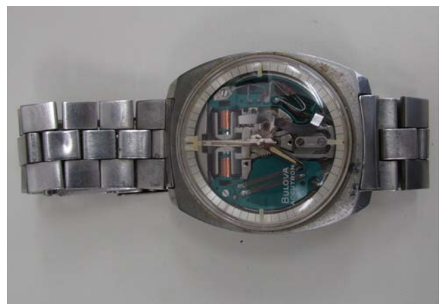
音叉腕時計 (1960年 スイス Bulova Accutron 製) [2]
