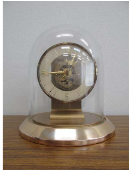
モータ時計(ゼンマイ駆動の代わり) (年代不詳 東京時計製) [1]
