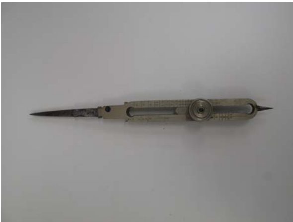
比例コンパス(長さ、面積、体積、円などの拡大や縮小) [1] ブラニメータ (地図など平面上の図形の輪郭をなぞることにより、その面積を計測する装置)
