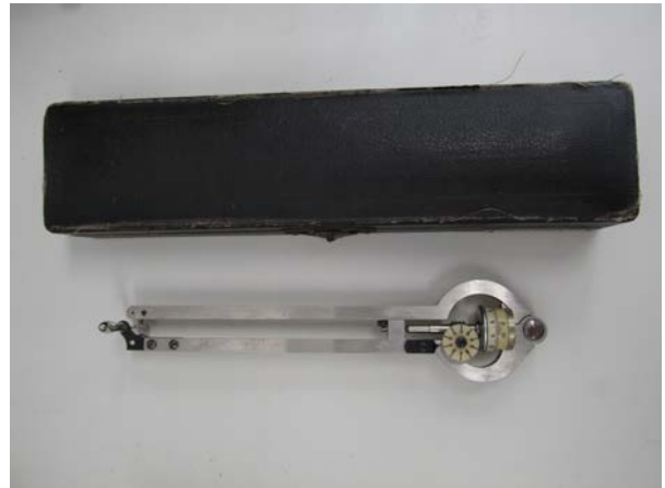
比例コンパス(長さ、面積、体積、円などの拡大や縮小) [1] ブラニメータ (地図など平面上の図形の輪郭をなぞることにより、その面積を計測する装置)
