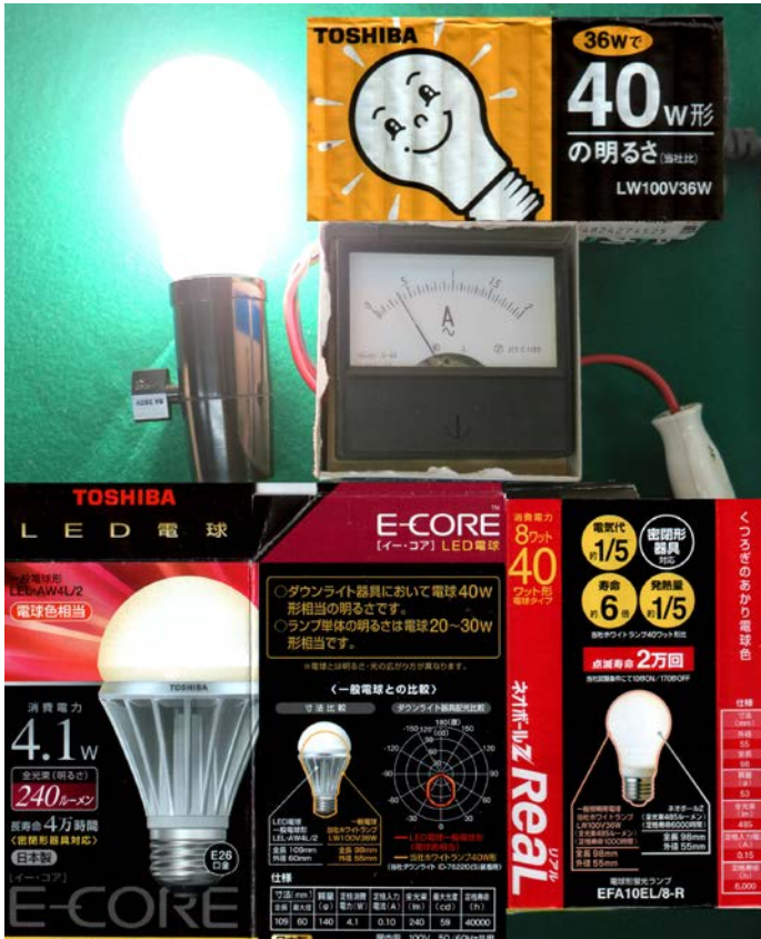
白熱電球・蛍光灯・LED 電流測定比較実験
