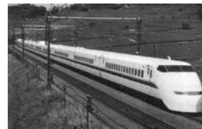
300系 (1992年~)、 500系 GTO + PWM 制御 電力回生ブレーキ
