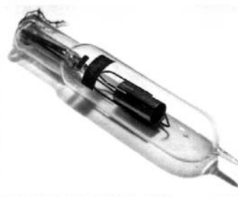
岡部が発明した分割陽極型マグネトロンを試作品
