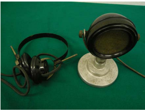
電磁式ヘッドホンと炭素粒マイクロホン[1]
