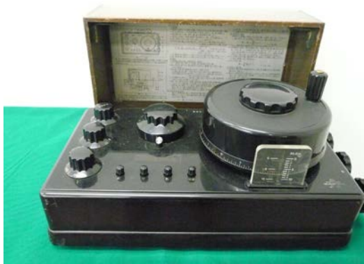
ポテンシオメータ（電流ゼロで起電力を測定）
