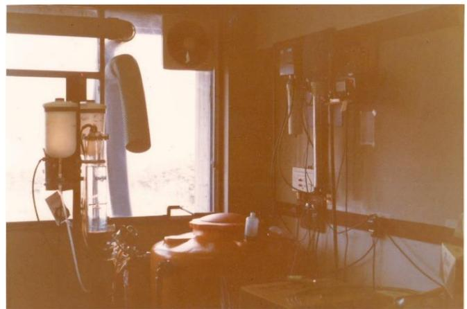
EPW による Si エッチャ、熱リン酸による SiN エッチャ、Si 電解エッチング装置
