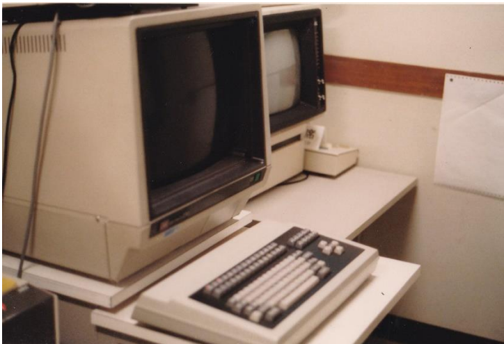
DEC 社 LSI11 に接続したディスプレイ (ヤマハ社 SIT 使用) レイアウトエディタは Fortran で自作(プログラミングの勉強)
