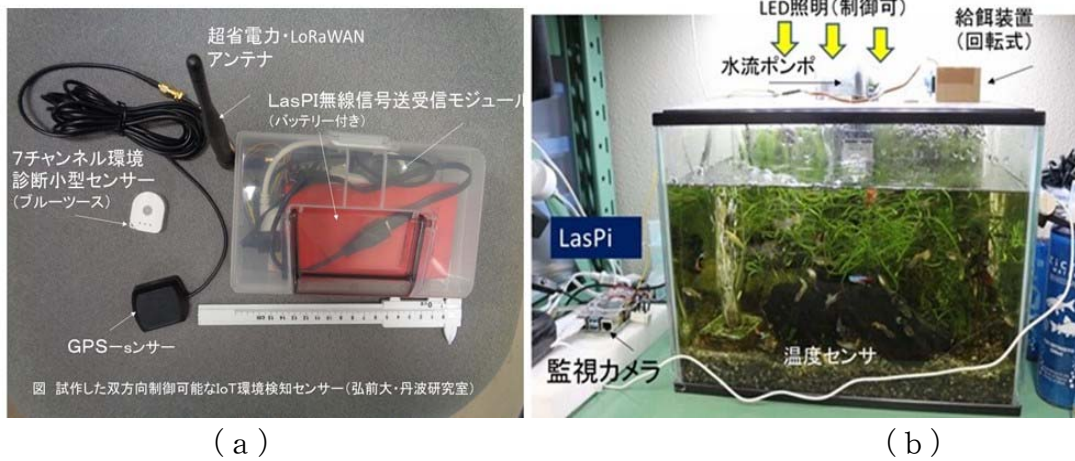
図9 超省電力型通信 (LoRaWAN) を組入れた、遠隔的双方向IoTセンサネットワークモジュール (a) と人工養殖 (水温管理、餌やり自動化) 用水槽小型モデル (b) 写真
